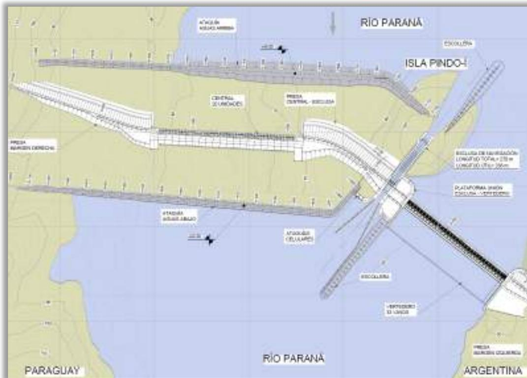
Continúa con la construcción de las ataguías que materializan el recinto entre la isla Pindo-í y la margen derecha, para proceder a la construcción de la central, y los dos tramos restantes de presa de CFRD.
